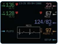
Il nuovo schemo a colori facilita il monitoraggio dei segni vitali di madre e feto al primo sguardo. I trasduttori sono abbinati a colori visualizzati sullo schemo per un riconoscimento rapido e privo di errori.
